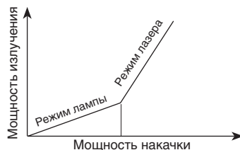
Рис. 19.6. Зависимость мощности излучения от мощности накачки
